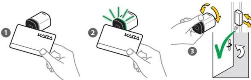
\*Bei nicht berechtigten Karten blinkt der Zylinder 4x rot und der Knauf dreht leer durch.
