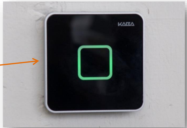
Halten Sie Ihre Zutrittskarte an den KABA-Sensor neben der Eingangstüre bis es Grün blinkt und die Türe hörbar entriegelt wird (dauert mehrere Sekunden).
